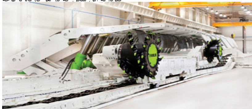
شکل ۱- مجموعه کامل ماشین آلات کارگاه استخراج (شیلد، شیرر، AFC)
