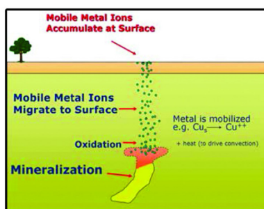
شکل ۱. شمای از مهاجرت مواد اکسید شده از عمق به سمت سطح
