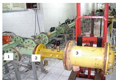
شکل ۲: تونل آزمایشی متصل به اتاق خلأ. (۱) انفجار، (۲) صفحه شکننده، (۳) اتاق خلأ
