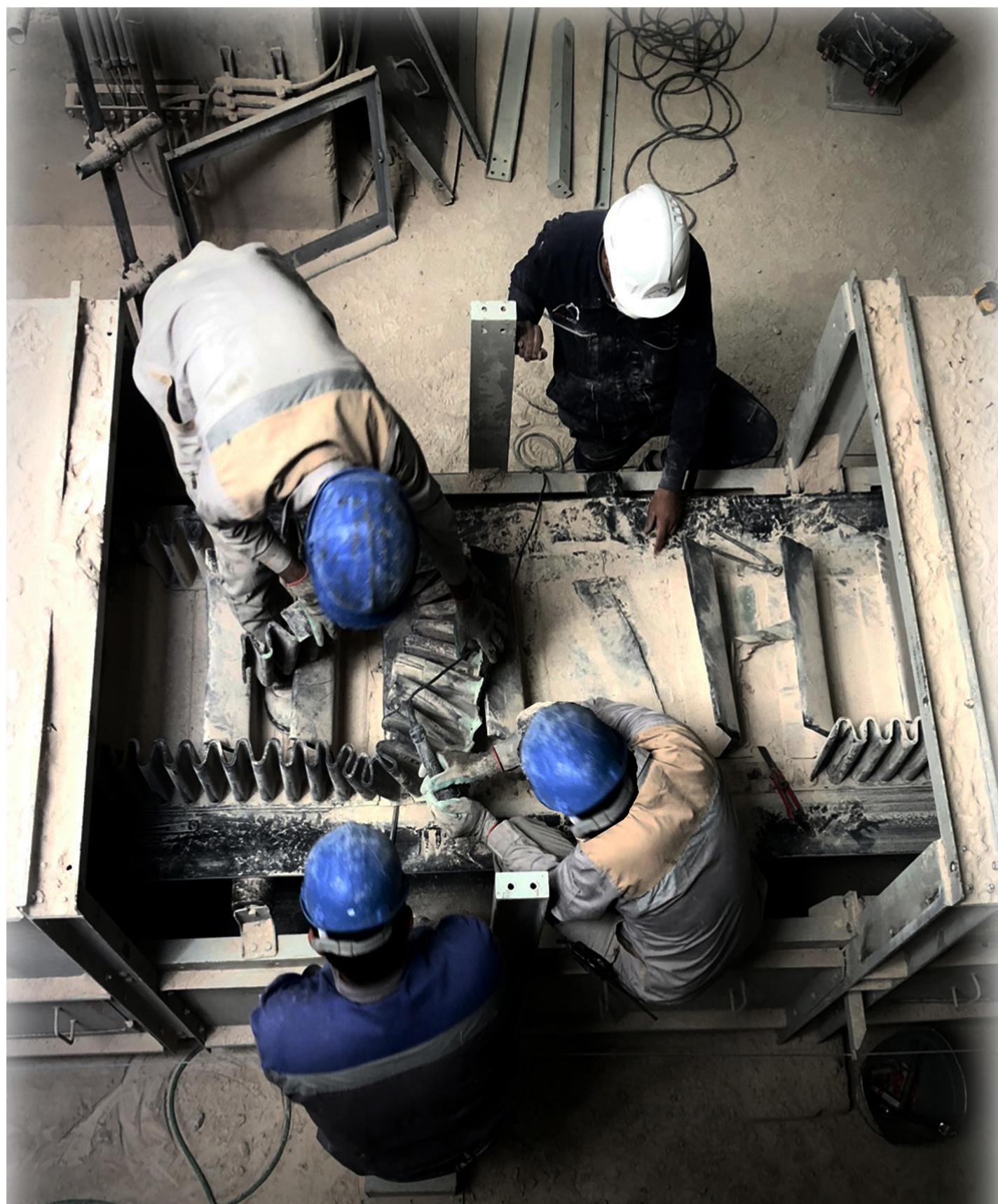
پرسنل مکانیک کارخانه پخت آهک و دولومیت در حال انجام تعمیرات و آپارات بر روی بلت استایپ فید محدوده فعالیت گرند هاپر
